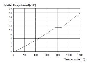
For 20°C  $\leq \theta_a < 750°C$ :  $\frac{\Delta l}{l} = 1,2 \ x \ 10^{-5} \theta_a + 0,4 \ x \ 10^{-8} \theta_a^2 - 2,416 \ x \ 10^{-4}$ For 750°C  $\leq \theta_a < 860°C$ :  $\frac{\Delta l}{l} = 1,1 \ x \ 10^{-2}$ For 860°C  $\leq \theta_a < 1200°C$ :  $\frac{\Delta l}{l} = 2 \ x \ 10^{-5} \ \theta_a - 6,2 \ x \ 10^{-3}$
